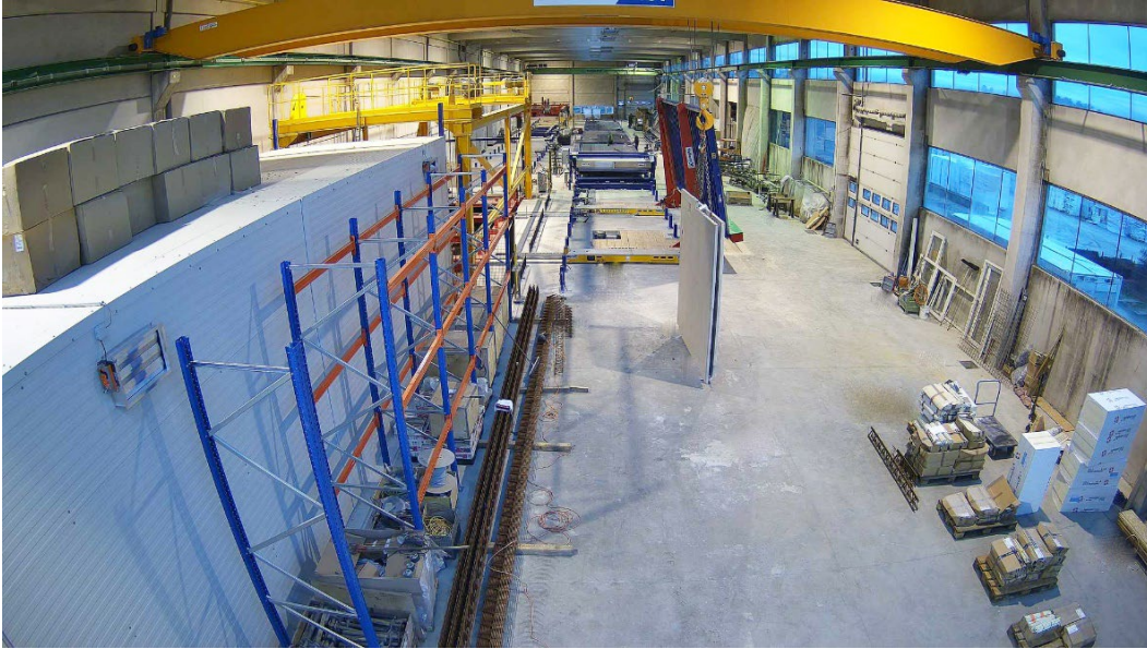
图 5 : Josef Lehner 的新双层墙壁制造系统的特点是其占地面积极其紧凑。
