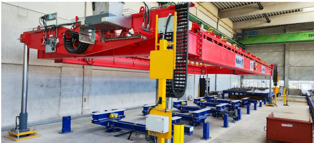
图 2： 在双层墙壁制造系统中，由固定式 VARIO TURN 托盘翻转设备负责半自动翻转过程。
