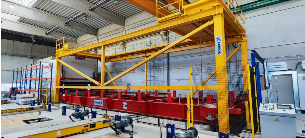
图 1： 完全绝缘的固化室和货架操作设备构成了 Josef Lehner GmbH 新双层墙壁制造系统的中央核心部件。
